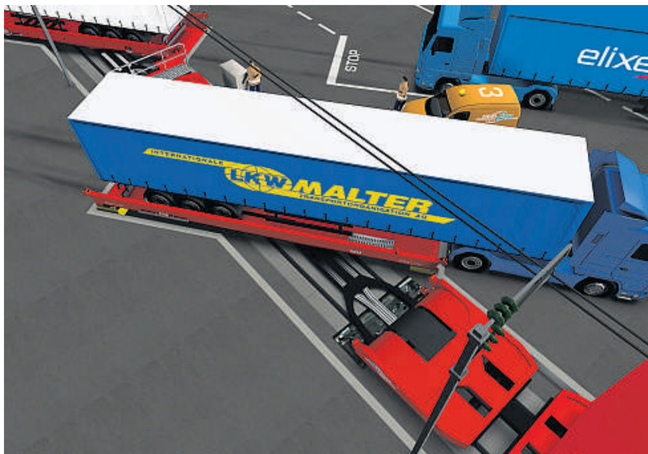
In 30 Minuten von der Schiene auf die Strasse: die Wannen der Modalohr-Wagen werden in den Terminals ausgeschwenkt. MODALOHR
